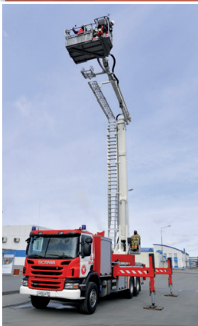
Стрела пеноподъемника выдвигается на 42 метра
